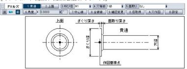
2. 小ねじ (最新 JIS 対応)最新 JIS 規格 (2007 年版) に対応した小ねじが作図できます。[オプション / 機械 / 最新 JIS 対応 / 小ねじ]
