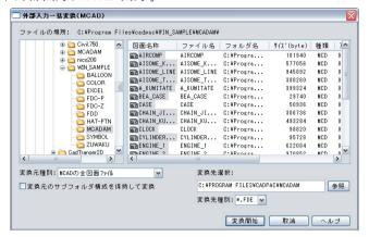
8. MCAD 入力 MCAD 出力 外寸内矢、補助線付き円寸法に対応しました。 [ファイル / 外部入力 /MCAD 入力] [ファイル / 外部出力 /MCAD 出力]
