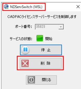
6. サービスを削除すると、サービス状態が「未導入」となり、[インストール] ボタンが押せるようになります。
